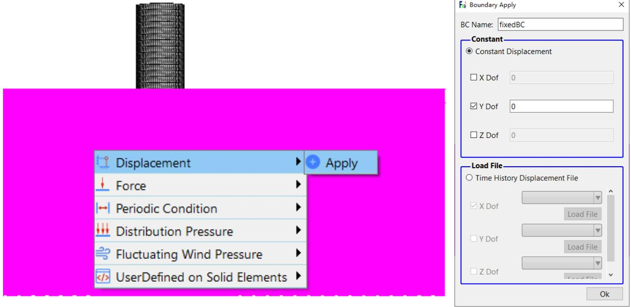
图 18-8 施加位移固定的边界条件
