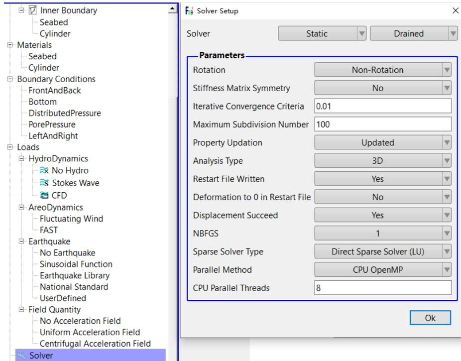
图 18-17 Step 1 中求解器的相关设置
