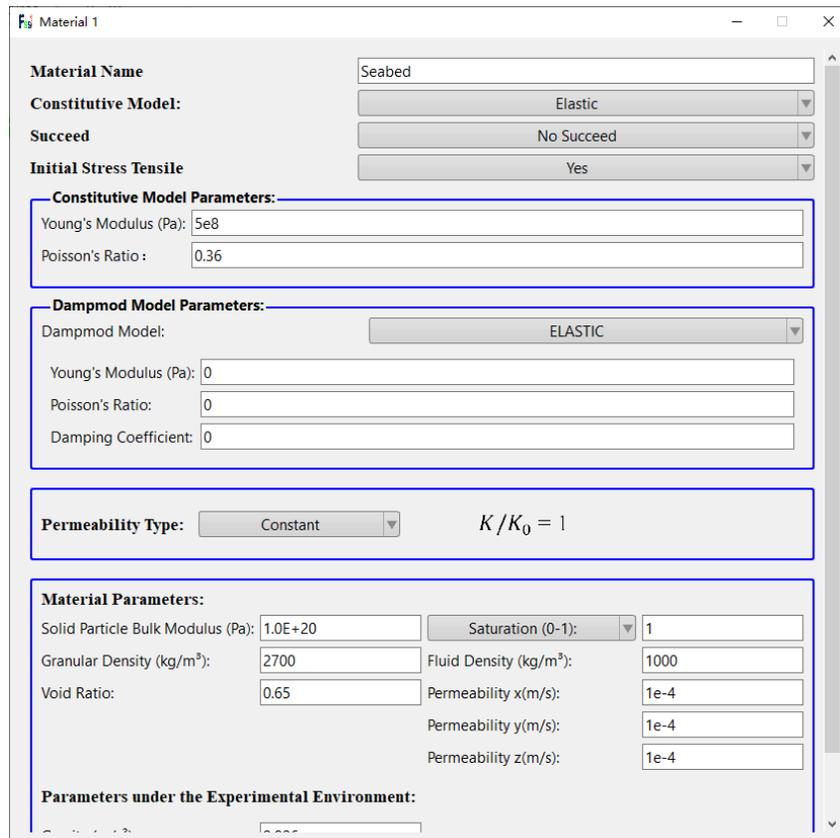
图 18-13 设置海床的相关参数
