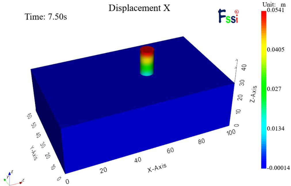
图 18-24  $t = 7.5$  s 时 X 方向的位移云图
