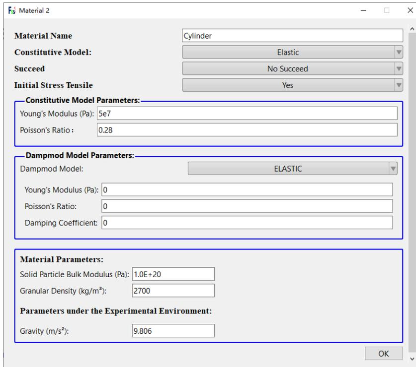
图 18-14 设置柱体的相关参数
