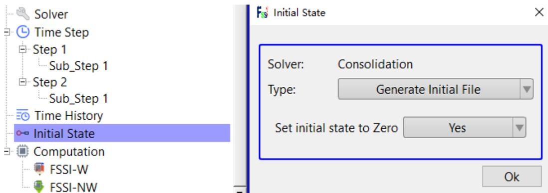
图 18-22 设置 Step 2 的初始状态
