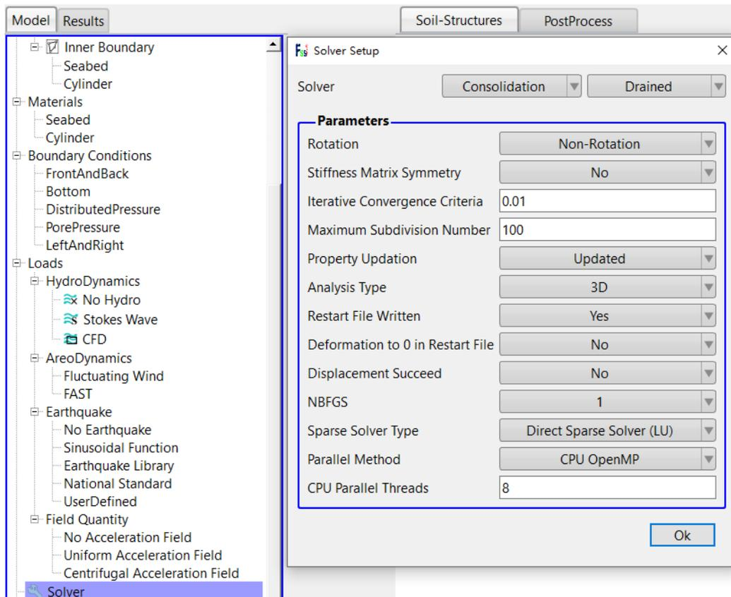
图 18-20 Step 2 中求解器的相关设置
