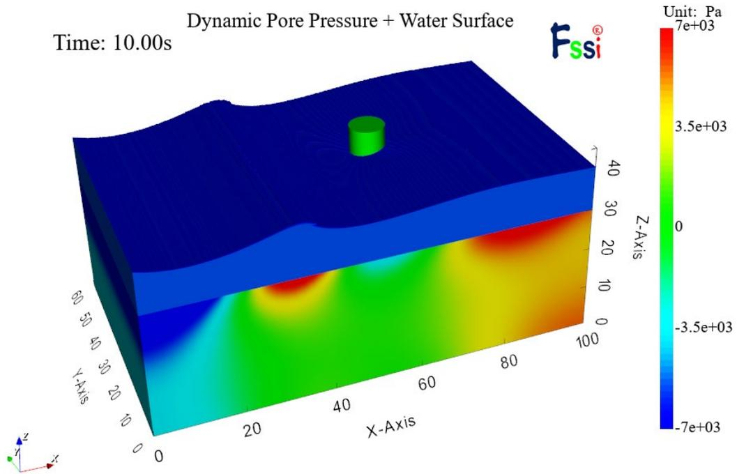
图 18-26  $t = 10\text{ s}$  时海床动态孔压和波浪自由面的分布图
