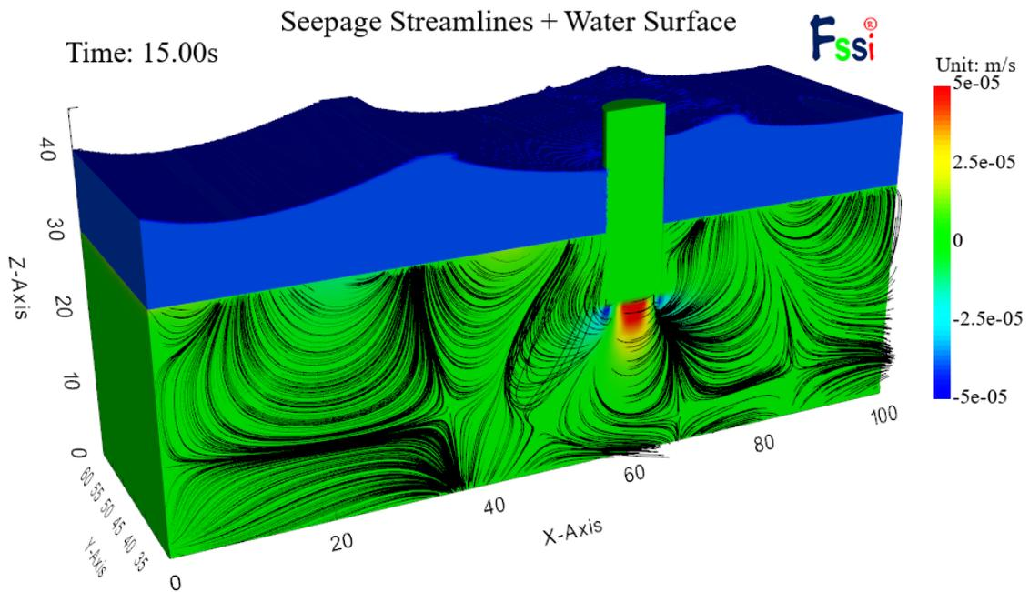
图 18-29 波浪自由面和土体渗流流线的联合分布图
