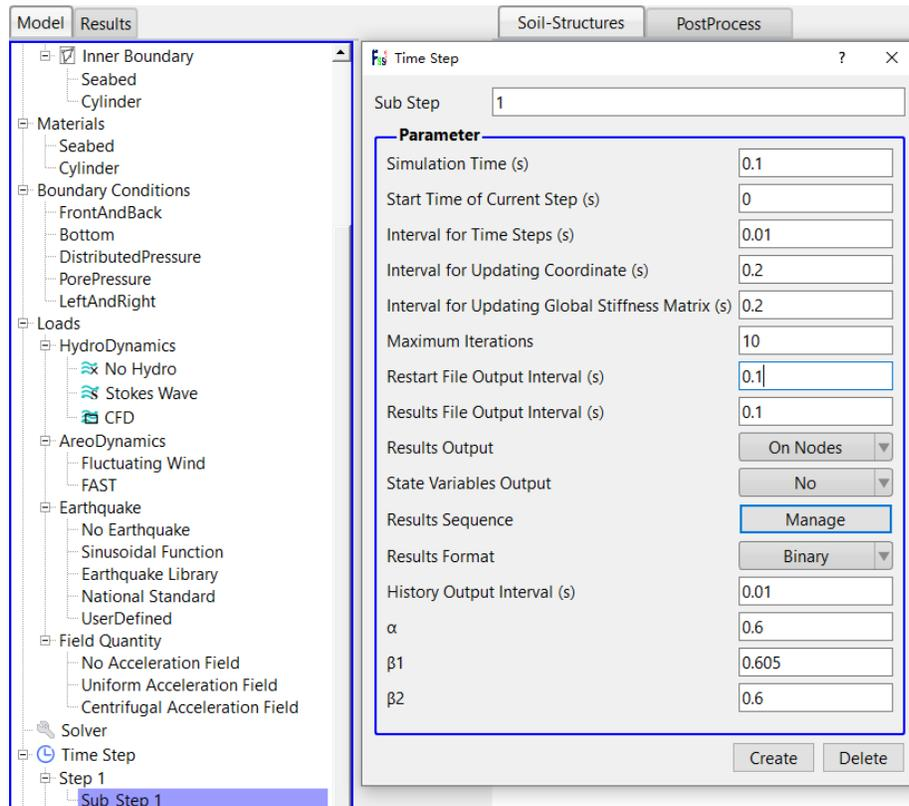
图 18-18 Step 1 中时间步的相关设置
