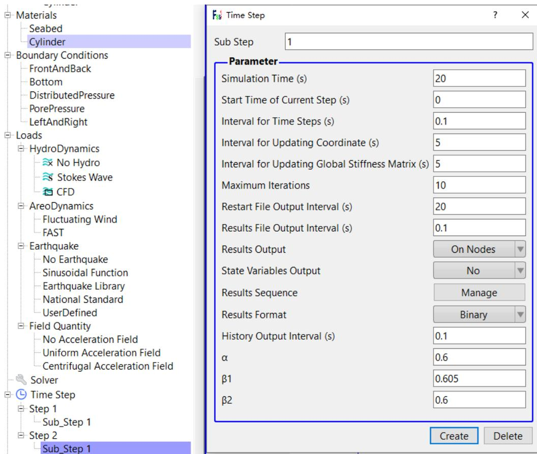
图 18-21 Step 2 中时间步的相关设置
