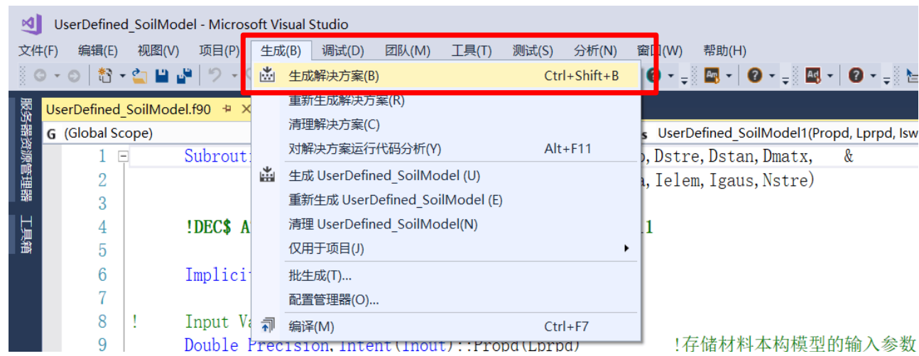
图 0-5 生成用户自定义边界条件 DLL 文件的步骤示意图
