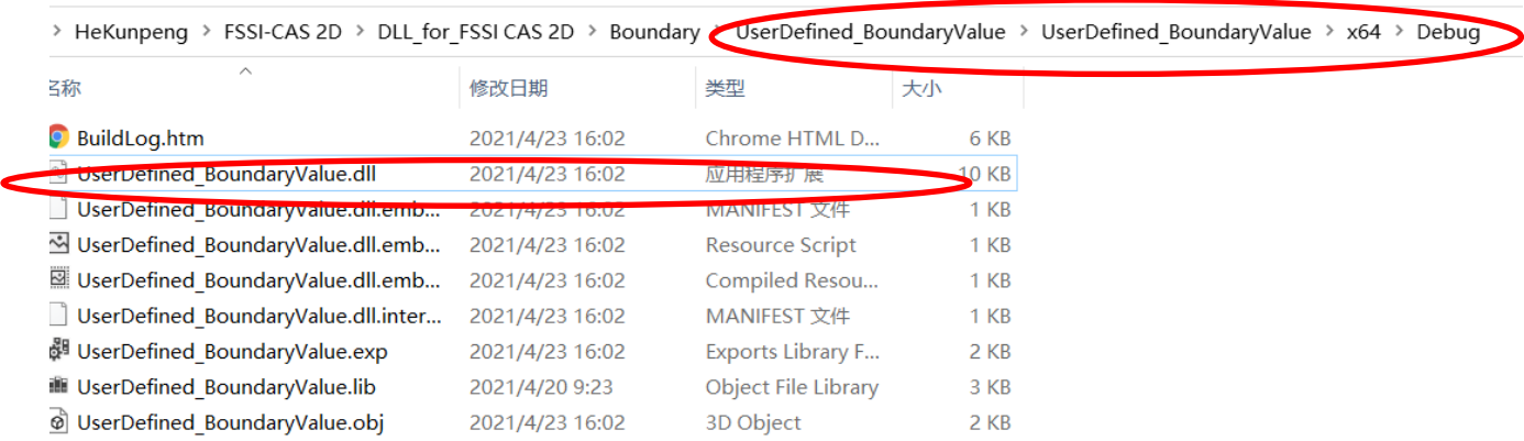
图 0-6 Debug 配置下 UserDefined_BoundaryValue.dll 文件的存储地址
