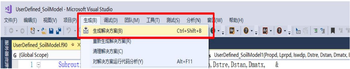
图 7-4 生成用户自定义材料本构 DLL 文件的步骤示意图
