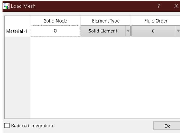
图 4 设置固体节点数和流体单元阶次
