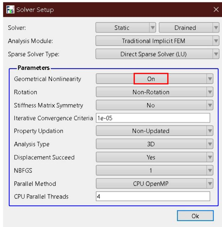
图 15 设置求解器相关参数
