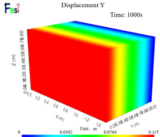
图 23 y 方向位移分布图
