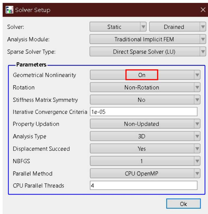
图 17 设置求解器相关参数
