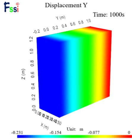
图 23 y 方向位移分布图
