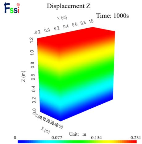
图 24 z 方向位移分布图
