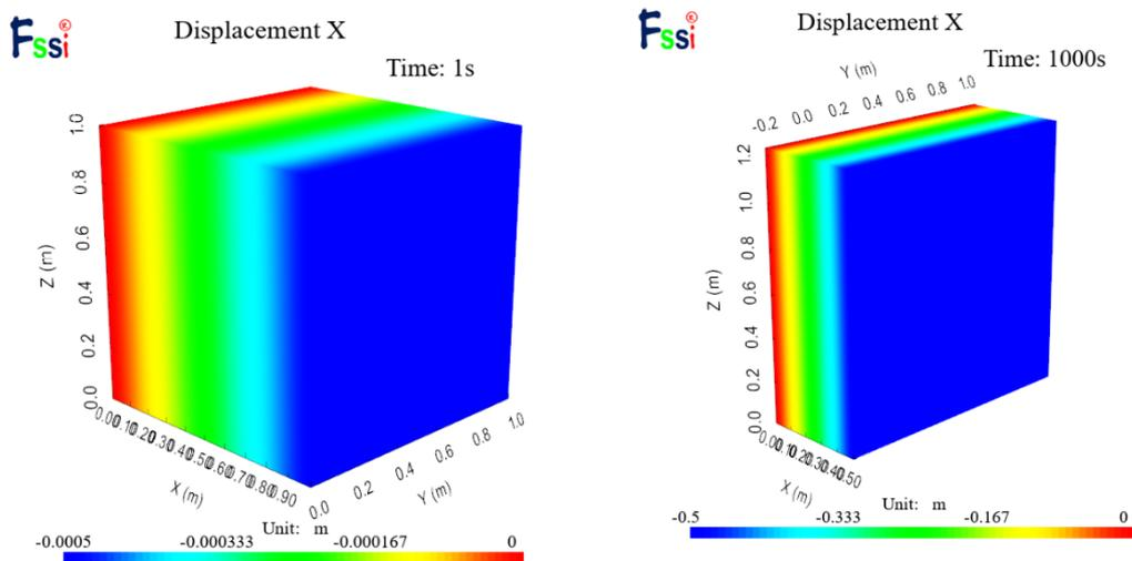
图 22 x 方向位移分布图
