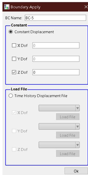
图 9 设置位移固定
