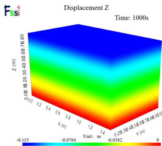
图 24 z 方向位移分布图
